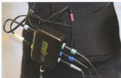
Чудо-пояс распределяет и направляет токовые импульсы в 6 основных зон
