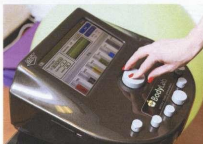
Аппарат, к которому и подключают пояс-распределитель, оснащен регуляторами мощности, таким образом, есть возможность увеличивать или уменьшать нагрузку
