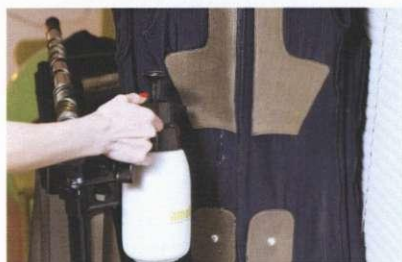
Костюм предварительно смачивают водой, чтобы усилить проводимость тока
