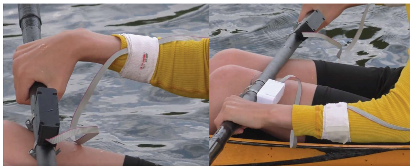
Рисунок 3 – Тензометрические датчики, закрепленные на весле спортсмена
