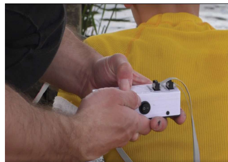
Рисунок 4 – Активация записи данных и помещение блока регистрации в лодку
