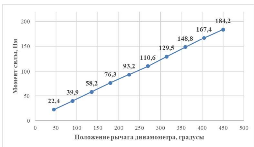
Рисунок 6 – Зависимость момента силы от величины поворота прижимного устройства
