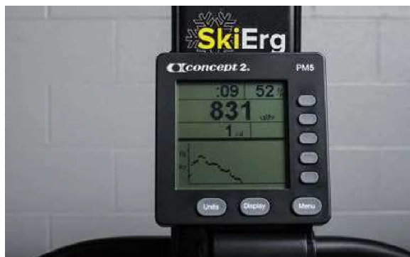
Рисунок 3 – Специализированные тренажеры для тренировки мышц верхней части тела спортсменов-лыжников: тренажер Ercolina, оборудованный устройством мониторинга и визуализации мощности движений (слева); монитор для визуализации параметров выполнения упражнений на тренажере SkiErg (справа)
