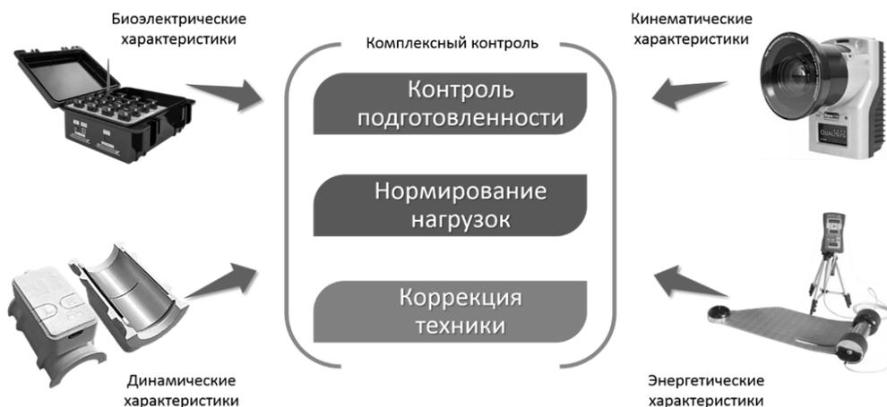
Рисунок – Измерительные средства для полипараметрического анализа движений спортсменов-гребцов
