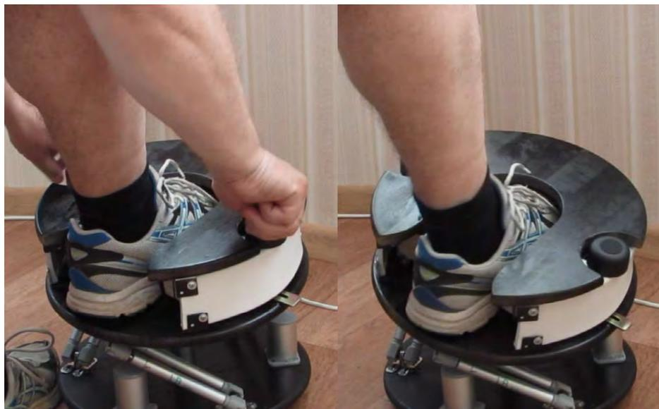
Рисунок 8. – Использование тренажерного устройства для развития силы мышц и реабилитации голеностопного сустава
