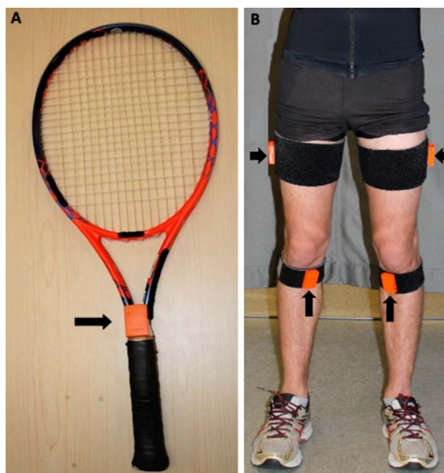
Рисунок 1 – Расположение датчиков. Черные стрелки указывают расположение датчиков на: (А) ракетке; (Б) голенях и бедрах. В данном исследовании были проанализированы движения только одной нижней конечности (ведущей ноги).
