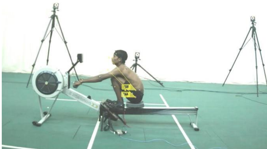
Рисунок 3. – 3D положения гребца в фазе захвата движения и видеоанализ биомеханики гребли углов бедра и туловища в фазе захвата (начало проводки)
